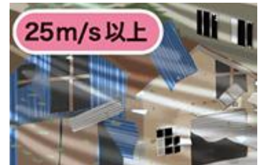
取り付けの不完全な外装材が飛び始める
